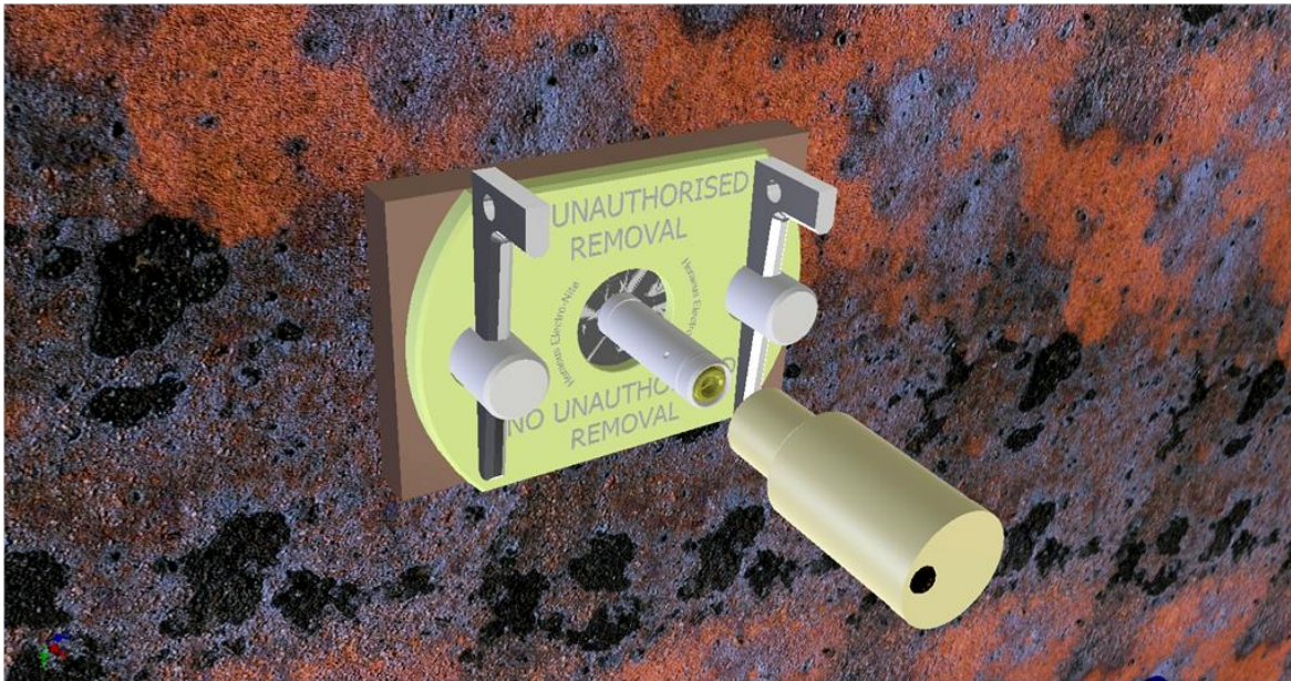
Abbildung 45 Setzen Sie den Sensorprüfer auf den Sensor.
