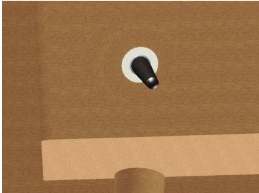
Abbildung 51 Dies zeigt den im Verteiler sitzenden CasTemp-Sensor.
