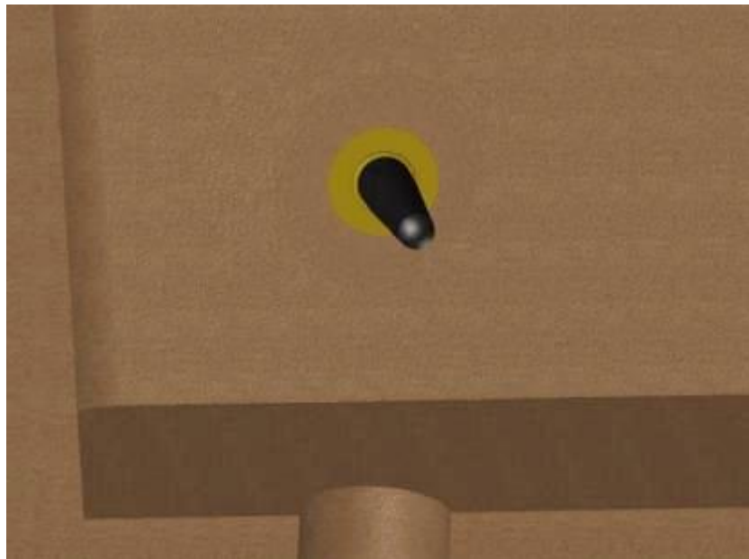
Abbildung 52 Sobald der Sensor eingebaut ist, verschließen Sie die um den Sensor liegende Fläche mit CasTemp Mörtel.
