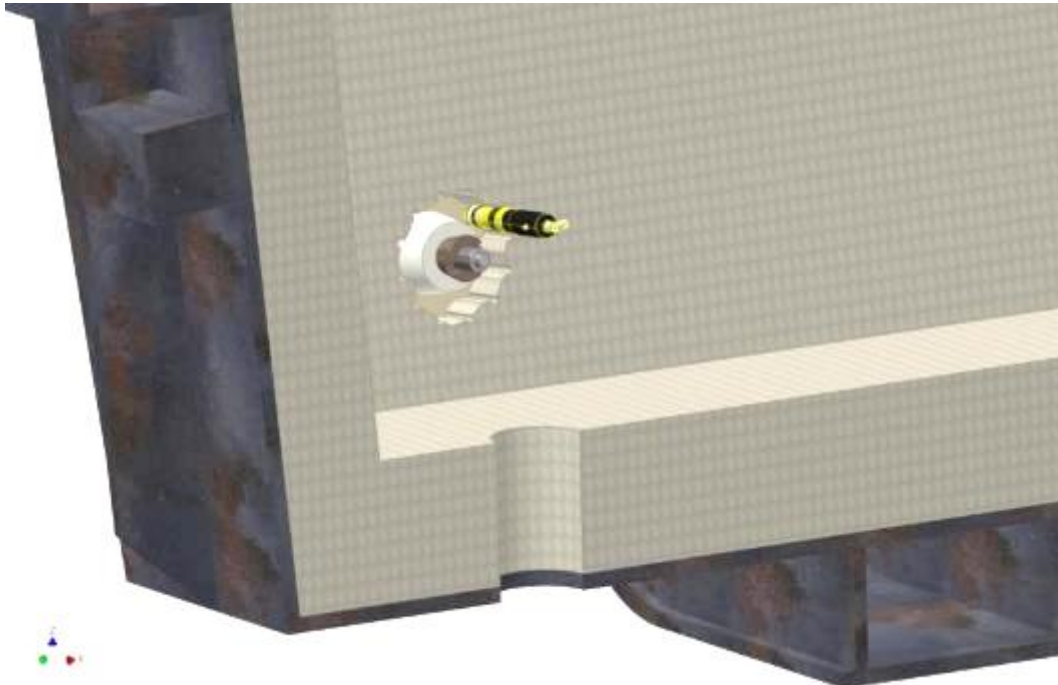
Abbildung 36 Verwenden Sie einen pneumatischen Hammer, um die Stampfmasse um den Block zu füllen und alle Lücken zu schließen.
