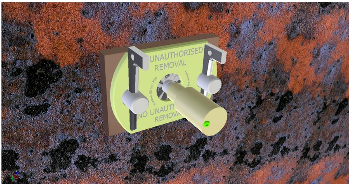
Abbildung 46 Ein grünes Licht bedeutet, dass der Verteiler nun ausgekleidet werden kann.
