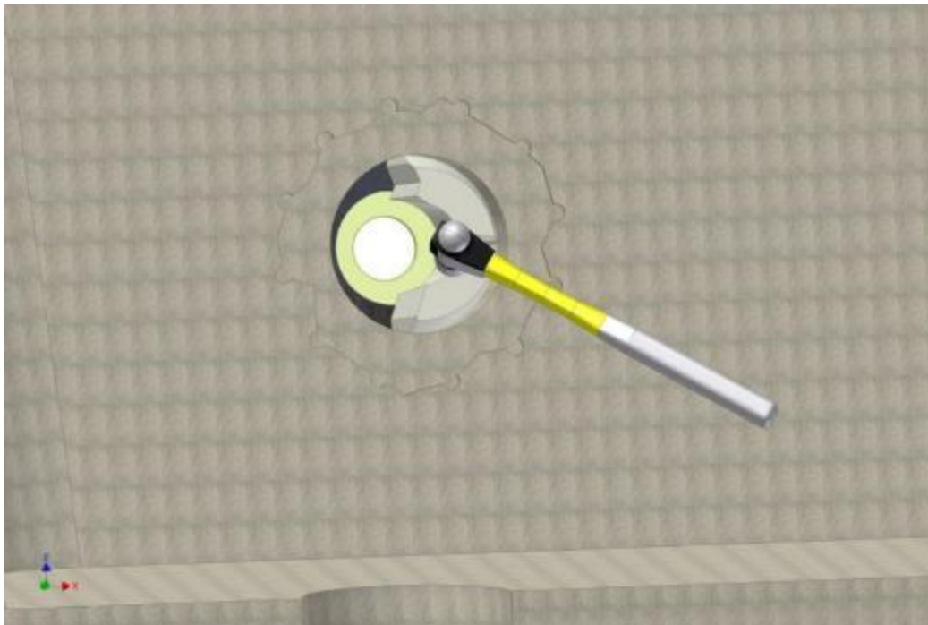
Abbildung 29 Wenn der Block eine saubere Öffnung hinterlässt, müssen Sie diese öffnen, um Platz für das verformbare feuerfeste Material zu schaffen.
