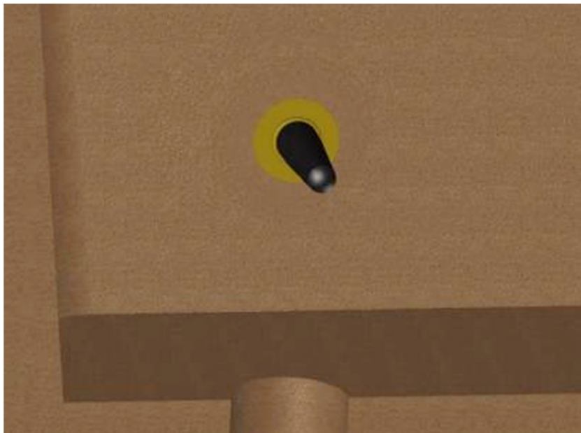
图 52 安装传感器后，用磷酸 盐结合的氧化铝耐火泥密封 热面。
