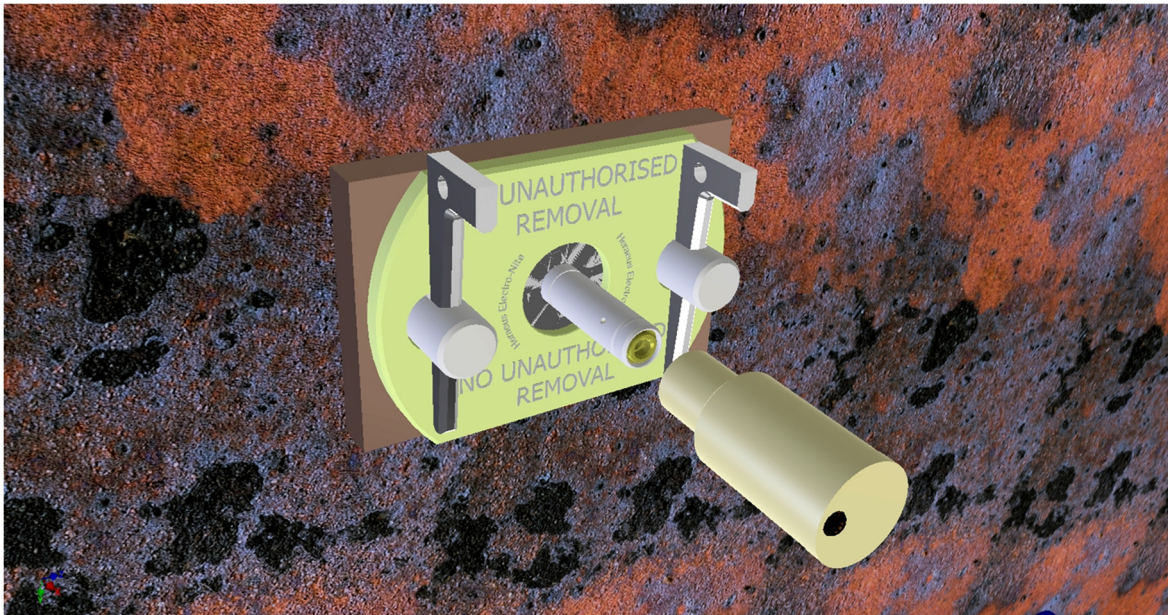
图 45 将传感器检测器推至传感器上
