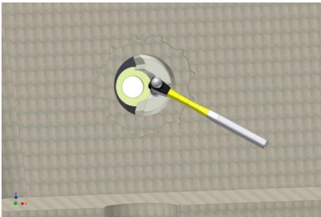
图 29 如果座砖留下一个完整的洞孔，必须开凿该洞孔，以容纳可塑耐火材料。
