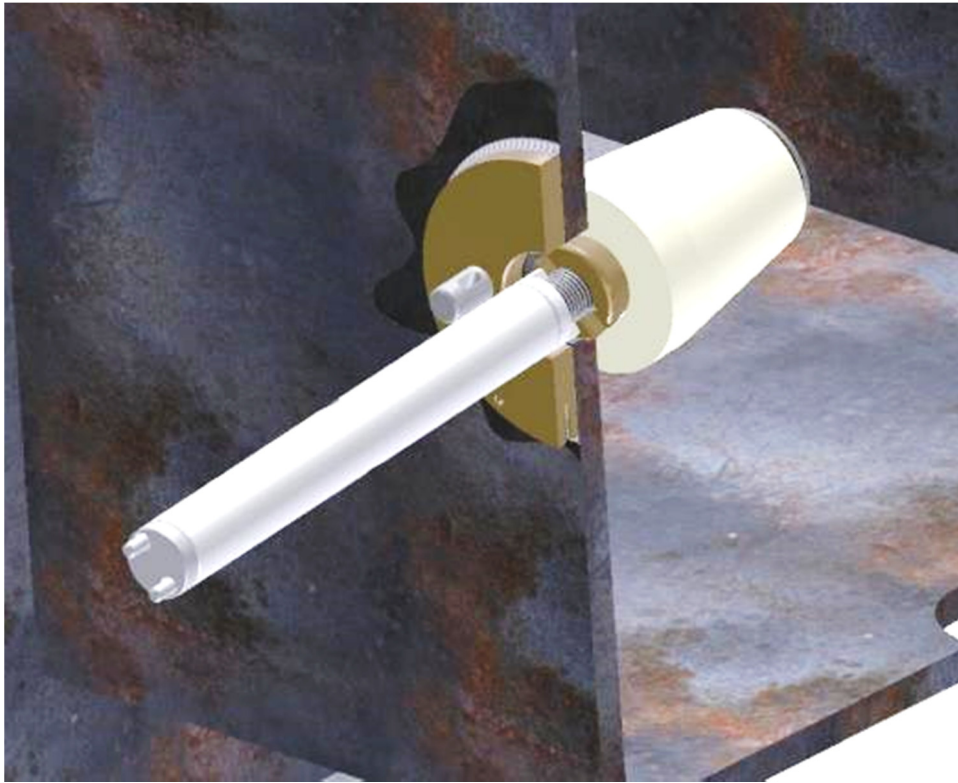
图 17 可以使用调整工具轻易地从中间包外侧松开和锁上嵌入工具
