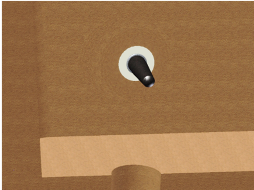
图 51 此为安装在中间包里面的 CasTemp 传感器。
